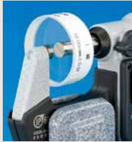
El paralelismo se puede estimar usando una paralela óptica colocada entre las superficies de medición. Primeramente, adhiera la paralela a la superficie de medición del tope. Luego cierre el husillo sobre la paralela usando la fuerza de medición normal y contar el número de franjas rojas de interferencia que se observan sobre la superficie de medición del husillo con luz blanca. Cada franja representa la mitad de la diferencia de longitud de onda en altura ( $0.32\mu\text{m}$  por franja roja).
